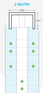
← 1280 → ← 1120 → 1120 830 Ø POWER RECLINE Ø POWER HEADREST POWER LUMBAR E. USB CHARGERS  $\bigcirc$ 240V OUTLET  $\bigcirc$ **READING LIGHTS** Ę WIRELESS CHARGER
